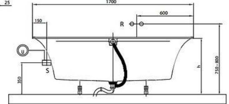
R = Пример расположения настенного смесителя S = Пример подключения электричества
