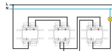
Схема подключения 2-х постового переключателя
