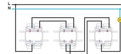
Схема подключения 2-х постового переключателя
